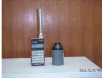
**Gambar 8.4. Noise Dosimeter**
