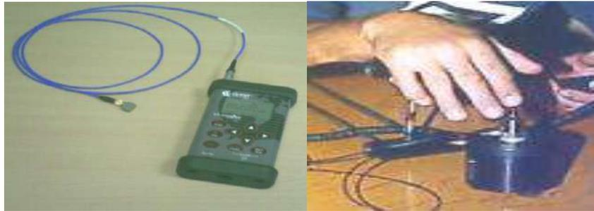
**Gambar 8.12. Vibrasimeter Untuk Pengukuran Hand Arm Vibration**
